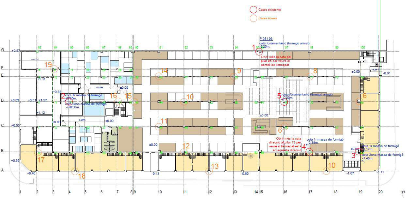
Cales en planta baixa per comprovació de la fonamentació. Agost 2023
